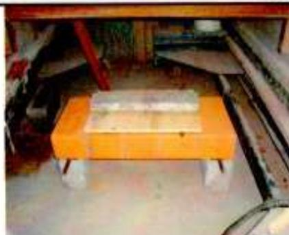
Foto 01 – Visualização do ensaio de flexão
